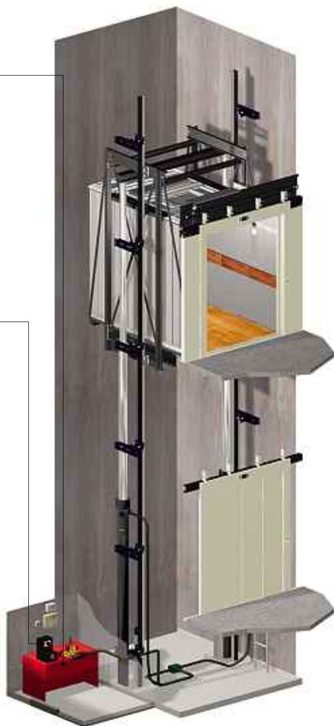
Sistema de tracção hidráulico de dois êmbolos
