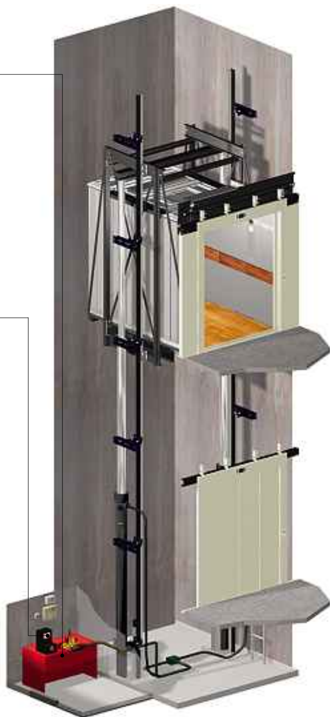
Sistema de tracção hidráulico de dois êmbolos
