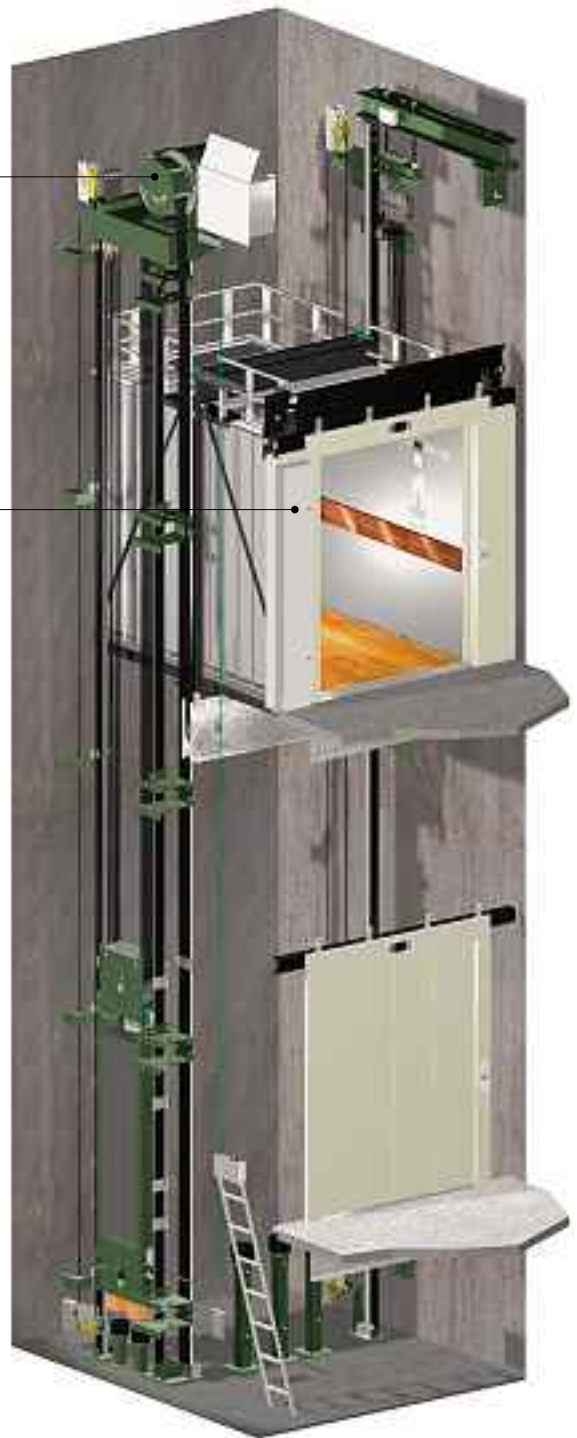
Elevador eléctrico sem casa de máquinas
